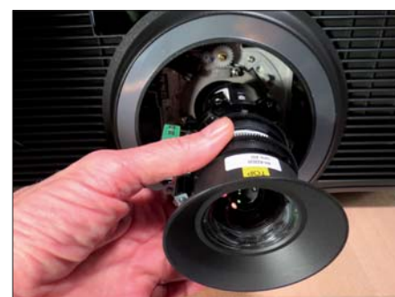
Mit einem Handgriff lässt sich das Objektiv wechseln. Eine danach aufzusteckende Abdeckung schützt die Mechanik.
