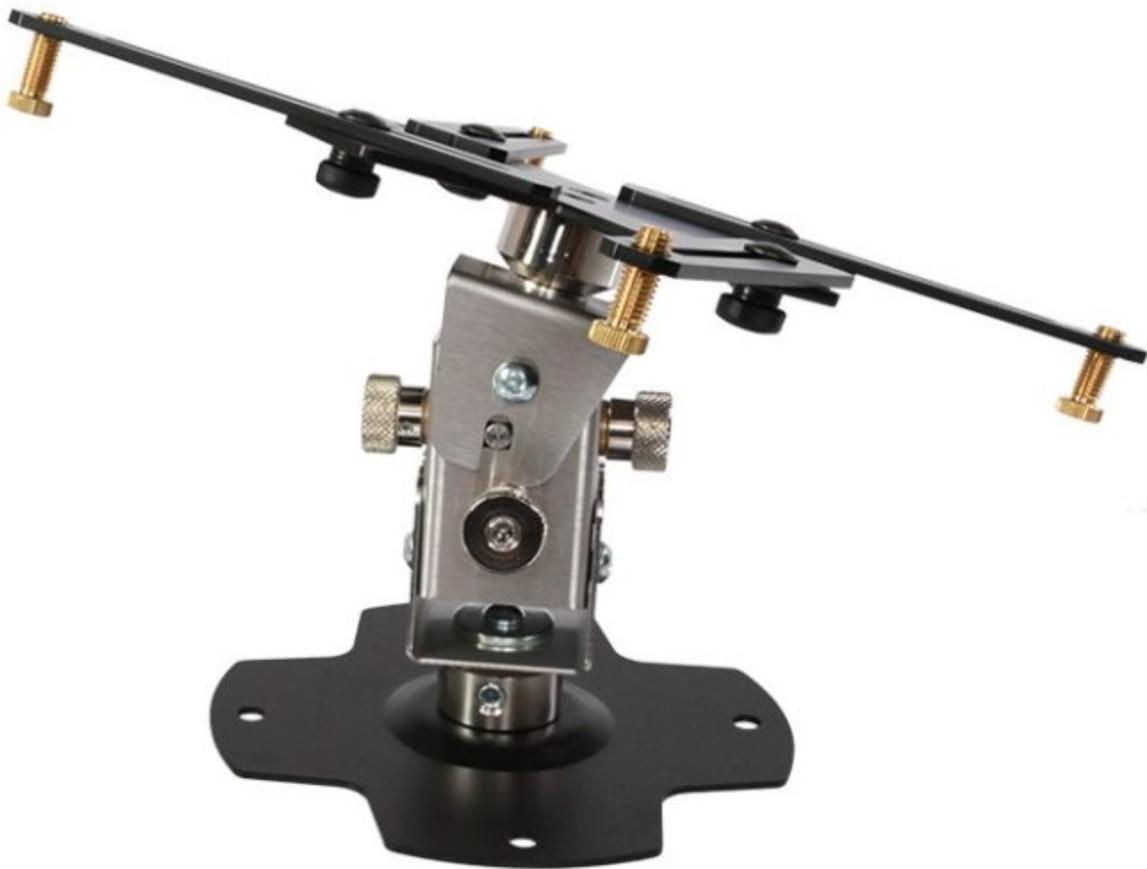
Die Arakno Deckenhalterung überzeugt durch ihr patentiertes Edelstahlgelenk. Damit kann die Projektorhalterung an nur zwei Hand-Einstellschrauben ohne Werkzeug angepasst werden. Es lassen sich alle Einstellungen millimetergenau ausführen - drehen um 360 Grad, Kippen, Neigen, Senken in alle Richtungen bis 45 Grad. Die max. Spannweite der Befestigungsarme beträgt bei der ARAKNO Deckenhalterung bis 440 mm. Für größere EIKI Projektoren bieten wir spezielle Montageplatten als Option an.
